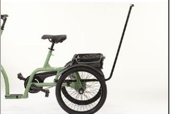
**963** Maniglione STERZANTE, per l'assistente, regolabile in altezza. Non installabile in presenza dei componenti 881 o 882.
